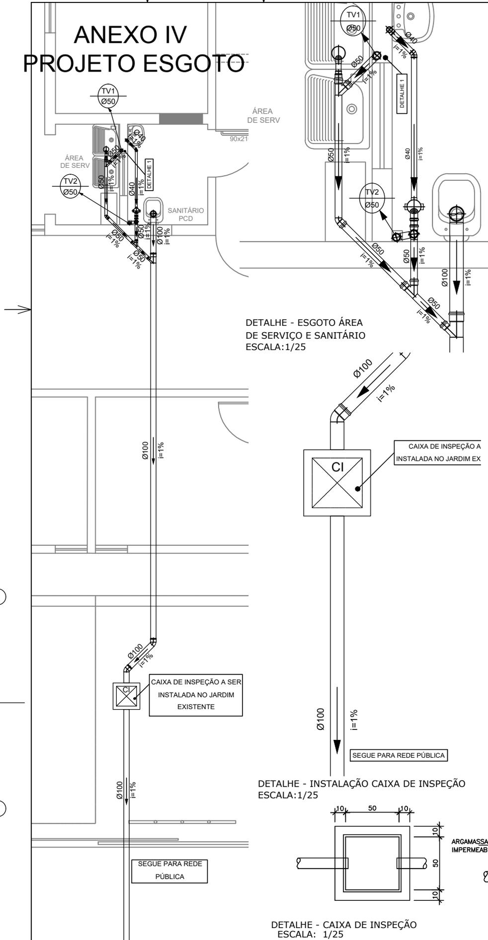
DETALHE - ESGOTO ÁREA DE SERVIÇO E SANITÁRIO ESCALA: 1/25
