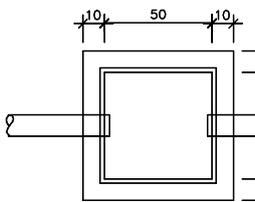
DETALHE - CAIXA DE INSPEÇÃO ESCALA: 1/25
